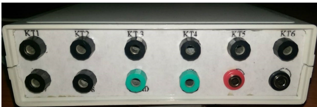
фиг.10.3 Изглед на пулта с контролните точки.
