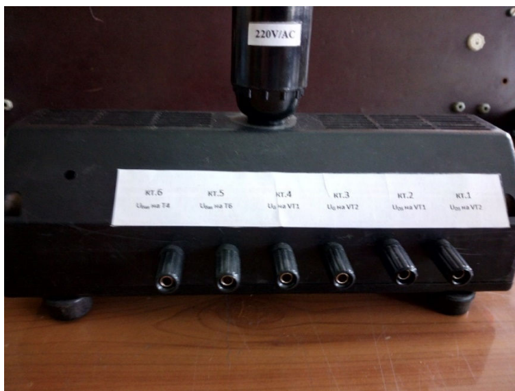
Фиг. 11.7. Външен вид на лабораторен макет за изследване на транзисторен преобразувател с ШИМ за слънчев панел.
