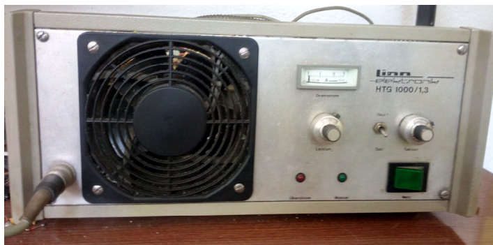
Фиг. 7.6. Уредба за запояване LINN HTG1000/1,3.
