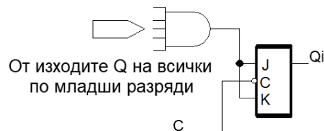
Фиг. U5.4. Синтез на пълен четириразряден сумиращ синхронен брояч
