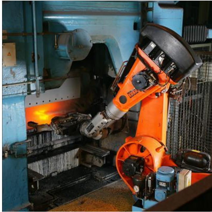
Фиг. 4.2. Пример за автоматизация и роботизация на лярски процеси (KUKA Roboter GmbH, 2003)
