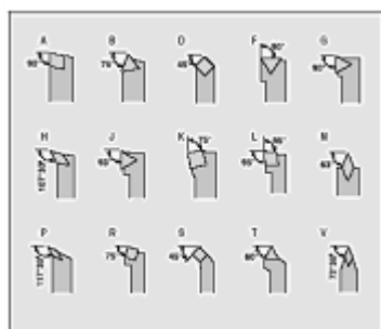
Фиг. 3.8. Означение по ISO 5608 на ножове със сменяеми пластини за обработване на външни повърхнини
