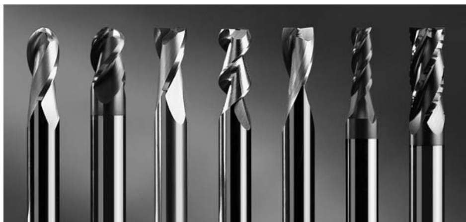
Фиг. 5.30. Гама твърдосплавни челно-цилиндрични опашкови фрези [28]
