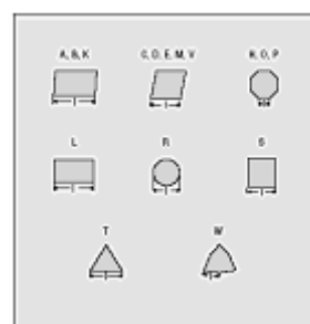
Фиг. 3.8. Означение по ISO 5608 на ножове със сменяеми пластини за обработване на външни повърхнини
