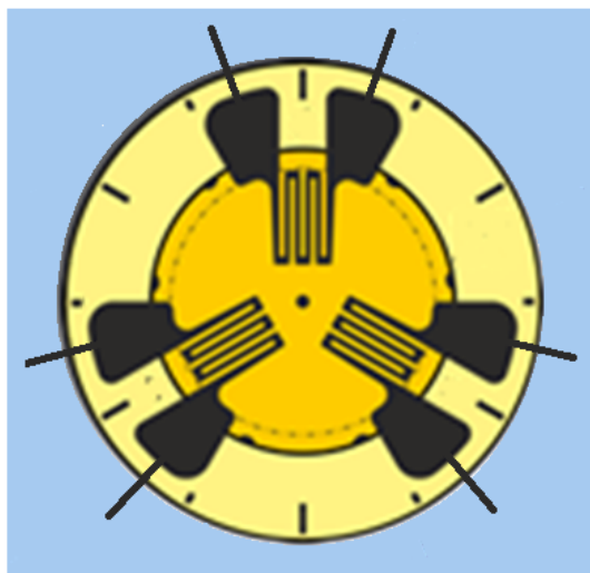
Фиг.4.3. Розетка от три тензорезистора за определяне на резултатното механично напрежение
