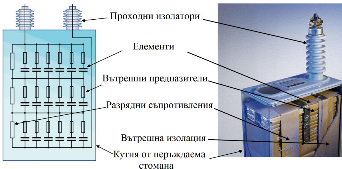
Фиг. 3.3-а) Схема на кондензатор за средно напрежение
