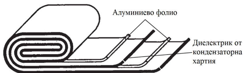
Фиг. 3.1. Конструктивно изпълнение на кондензаторна секция с хартиен изолационен слой между електродите
