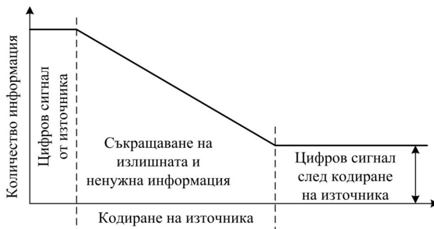
Фиг. 5.2. Схема за съкращаване на количеството цифрова информация
