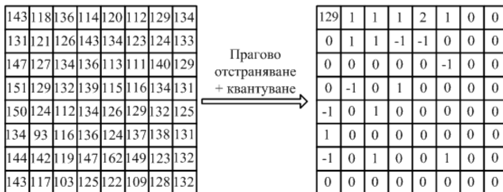
Фиг. 4.11. Прилагане на квантувана матрица при пространствен излишък
