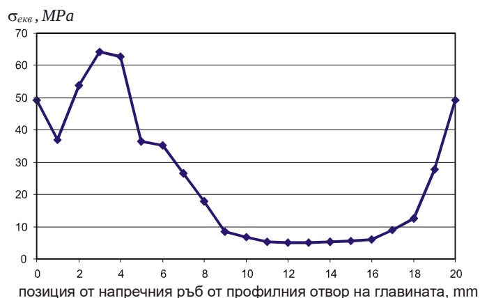
Фиг. 12.26. Разпределение на екв. напрежения от профила на главината в напречно сечение
