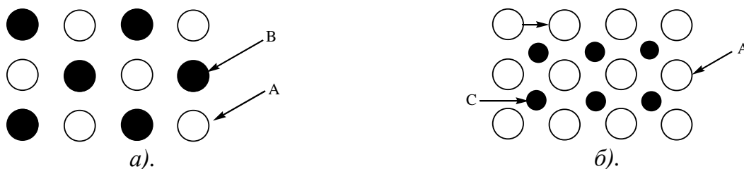
Фиг. 1.2. Образуване на твърди разтвори със симетрични подреждания на заместващия (а) или внедрен атом (б)
