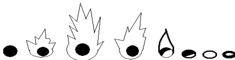
Фиг. 7.5. Схема на горене на частици от твърдо гориво
