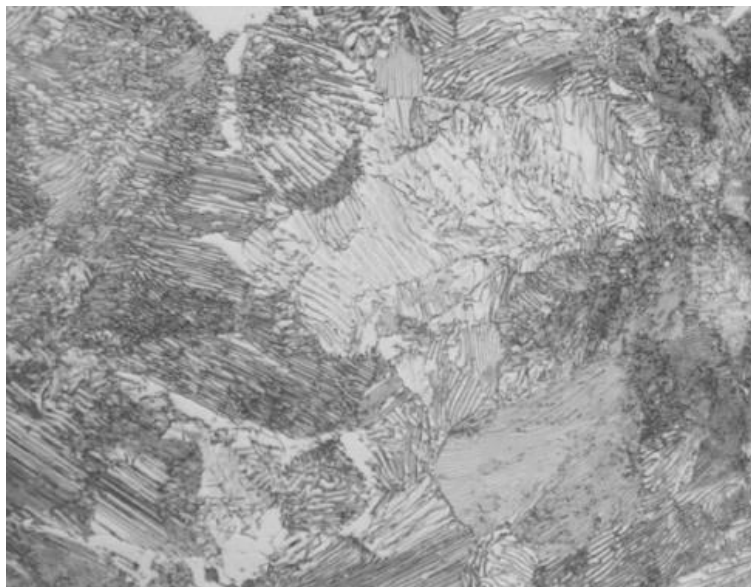
Фиг. 2.11. Перлитна структура на горещо валцована евтектоидна стомана с химичен състав 0.8\% C , 0.21\% Mn , 0.22\% Si [10]
