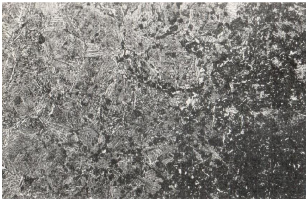
Фиг. 5.3. Мартензит, преминаващ в сорбит на закалена цементирана стомана 18ХГТ, \times 250 [4]
