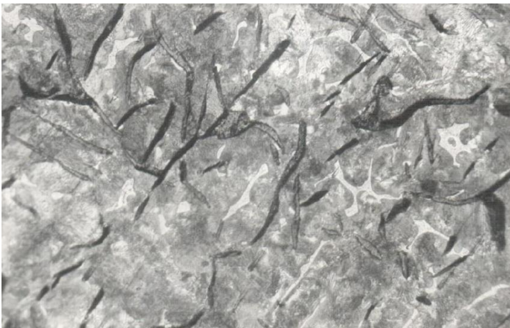
Фиг. 6.5. Ферито-перлитен сив чугун с пластинчат графит, x250 [4]
