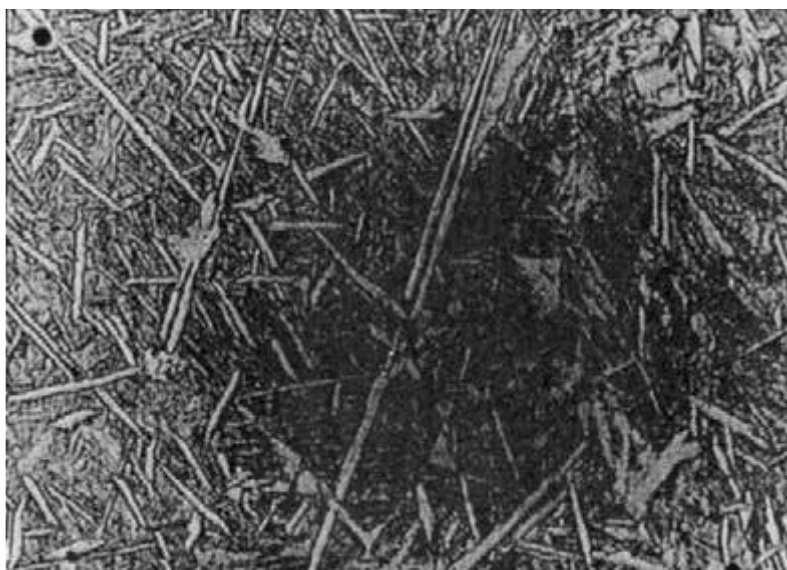
фиг. 3.8. Игловидни феритни плочи в мартензитна матрица в стоманен заварен слой, който е частично (непълно) закален [10]
