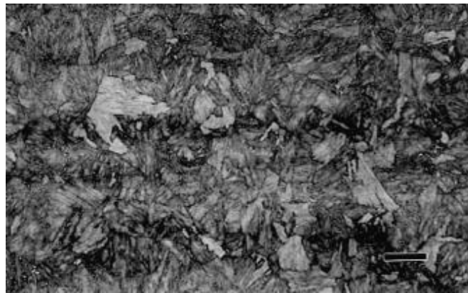
Фиг. 2.18. Мартензитна структура (увеличителен бар - 20\mu\text{m} ) [10]
