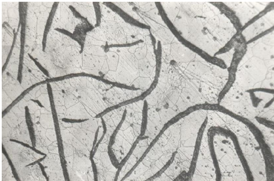
Фиг. 6.2. Структура на сив чугун (феритен, с пластинчат графит), x250 [4]
