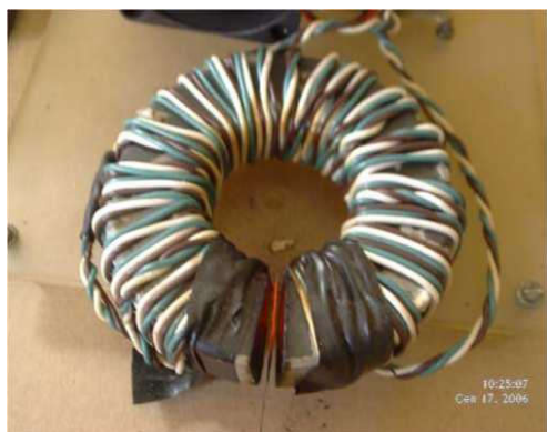
Фиг. 11.3. Индуктор за нагриване в магнитна верига
