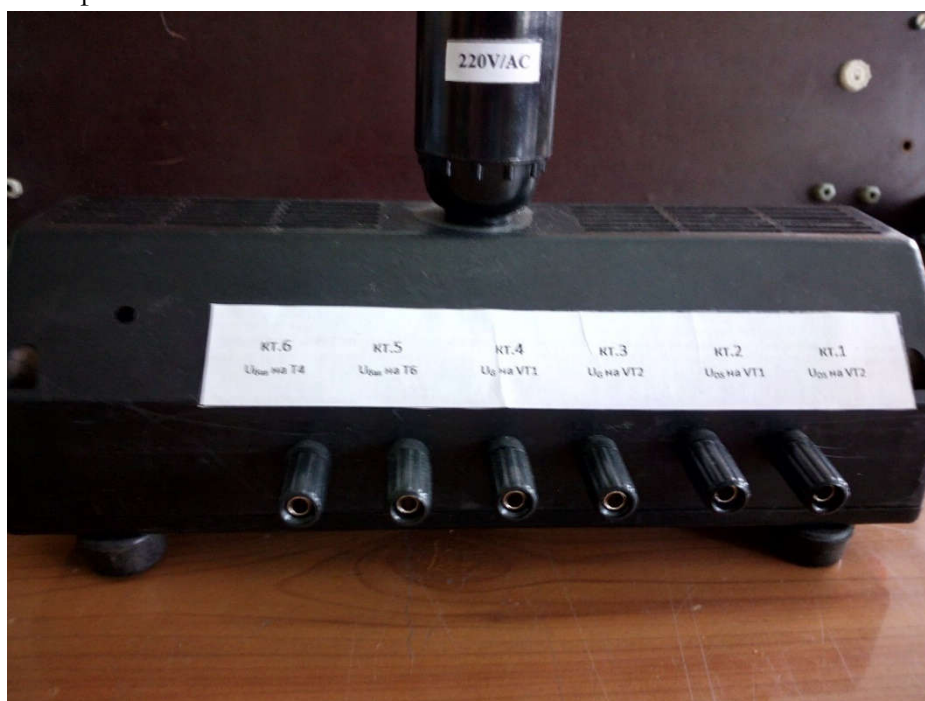
Фиг. 14.7. Външен вид на лабораторен макет за изследване на транзисторен преобразувател с ШИМ за слънчев панел.
